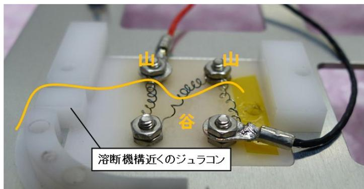
10. No.6 で作った4つの輪を半ネジに通し、半ネジを熔断機構の半ネジ用の穴に通す．ただし、半ネジには厚さ 0.2mm のワッシャーを通し、カプトンテープを貼り付け、シャープエッジを除去する．半ネジ用の穴にネジを通す際、半ネジと熔断機構の間にシムワッシャーを入れる．ここで、ダイニーマ2号の1本あたりの直径は 0.235 mm なので、4本合わせると 0.94 mm である．したがって、厚さ 1.0 mm のシムワッシャーを用い、ダイニーマに圧縮力がかからないようにする．
